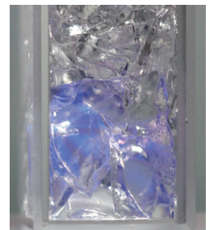
酸化亜鉛ナノ粒子を含有して青色発光するハイドロジェル
