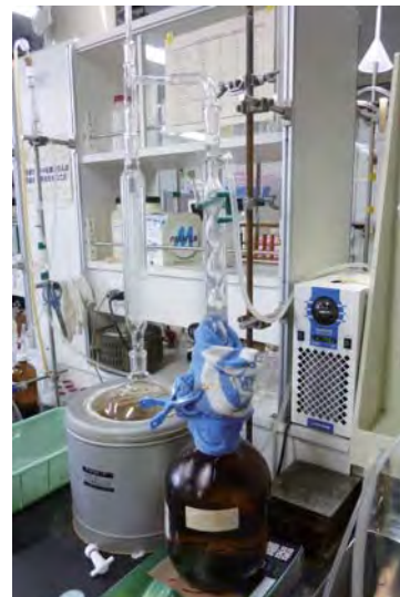
溶媒の蒸留装置に使用する冷却水循環装置
