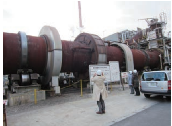
実験廃液、不要薬品等を焼却する大型キルン焼却炉 (住友化学新居浜工場内)。
