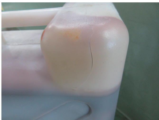
タンクの亀裂
