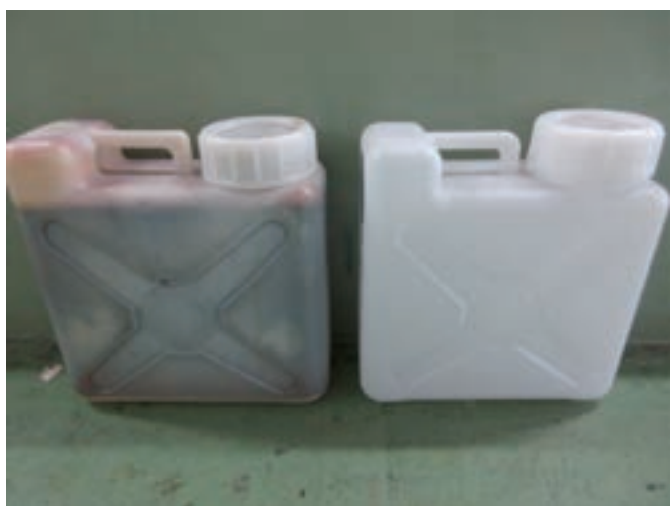
タンクの汚れ (左：使用済み 右：未使用)
