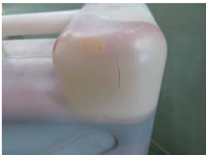
タンクの亀裂
