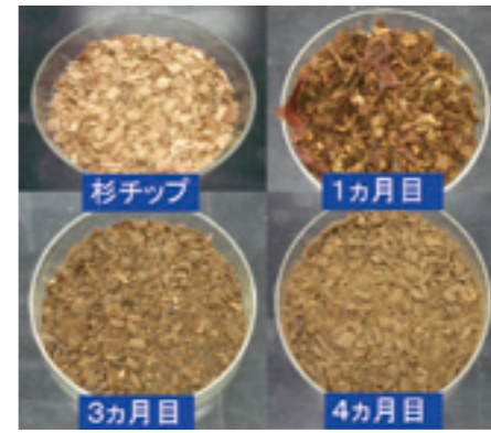
発酵分解中の汚泥
