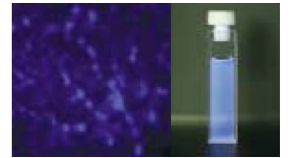
がんの早期診断にも応用できる酸化亜鉛ナノ粒子によるバイオイメージング(蛍光顕微鏡写真)(左)と蛍光を示す酸化亜鉛ナノ粒子の分散液(右)
