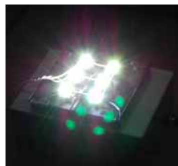
図-1 30W 窒化ガリウム系白色 LED(市販品)。
