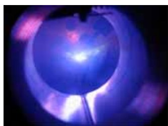
図-2 ZnO ナノ粒子を生成している様子。
