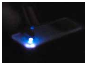
図-4 ZnO ナノ粒子の分散液を塗布して作製した青色発光ダイオード。
