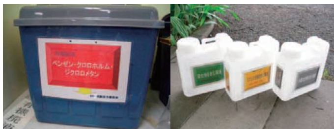
写真14 クロロホルム、ジクロロメタン、ベンゼン用および「硫化物を含む廃液」、「シアン化合物を含む廃液」の廃液タンク
