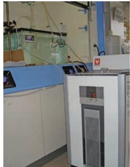
重合反応時に使用する冷却水循環装置
