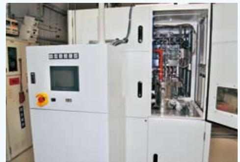
図-1 ZnO系薄膜成長用MOCVD装置
