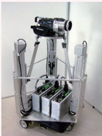
図2 パラレルリンク式 アクティブ吸振器
