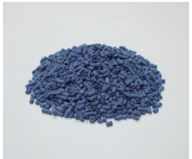
石油精製で実際に用いられている代表的な脱硫触媒の「コバルト-モリブデン水素化脱硫触媒」。酸化アルミニウムにコバルトとモリブデンを添加しています。
