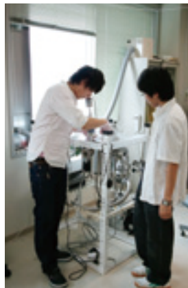
葉准教授の研究室では「スパッタ法」と呼ばれる手法で太陽電池パネルの薄膜を製作しています。写真はこれに用いる機材を学生たちがくみ上げているところ。
