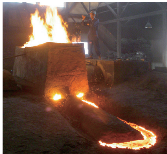
「たたら」の炉頂内の炎の状況を観察する木原明氏。たたら製鉄の全責任者である「村下」職は、細かな状況変化も見逃せない。(写真提供/木原明氏)
