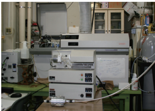
PM 2.5 の分析システム。10ミリ秒から5分ごとの測定が可能に。
