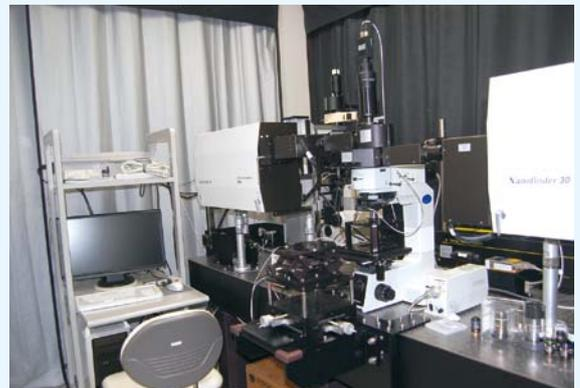
近紫外～近赤外レーザーと共焦点顕微鏡とAFMなどを組み合わせて生物・材料系の測定が可能な汎用ラマン分光装置を導入し、新しい研究分野を切り開く。
