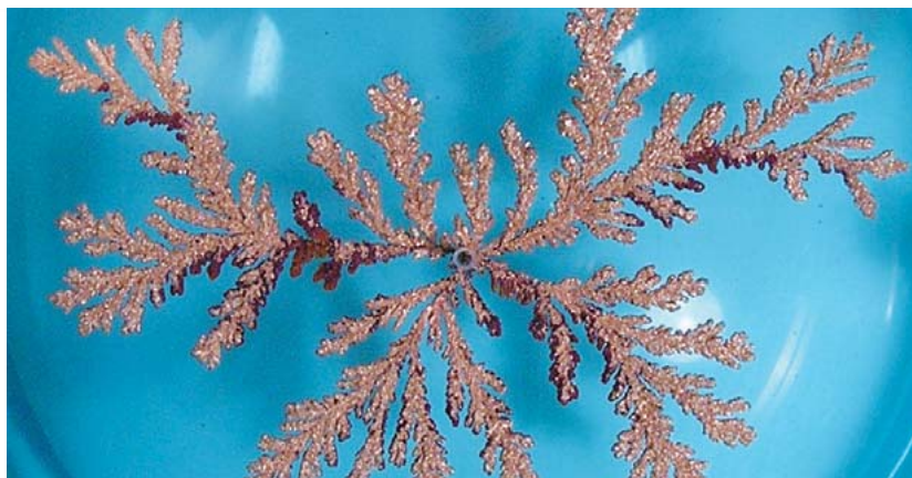
フラクタル成長・硫酸銅溶液の電気分解で銅がフラクタル状に析出する。この現象は、拡散律速凝集(diffusion-limited aggregation)モデルによって数学的に説明することができる。
