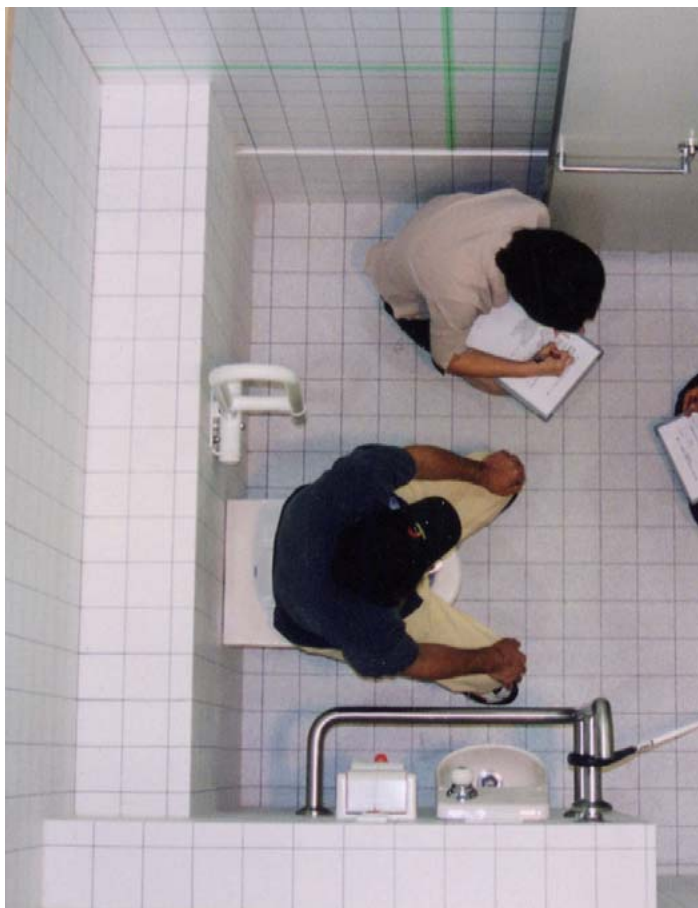
実物大模型(モックアップ)を使った実験検証。実際に障がいをお持ちの生きた生活者を対象とした実験を通して、より安全で快適な使い勝手を
