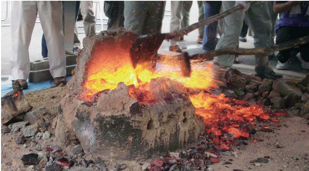
たたらの実習で炉を壊して鉤(けら)を取り出すところ。
