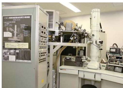
宮本准教授の研究室にある、世界的にも珍しいイオン照射装置直結型電子顕微鏡。高エネルギー粒子線照射下で起こる材料内部での特性変化を、ミクロな観点から観察できる。
