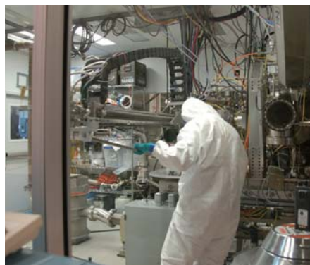
カリフォルニア大学サンディエゴ校にある、直線型プラズマ発生装置内での実験風景。人体に吸入されると毒性を示すベリリウムを利用するため、防護服が欠かせない。
