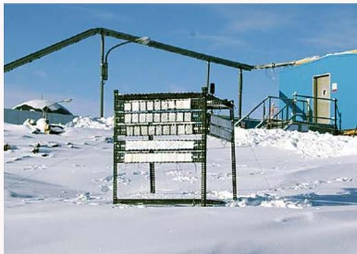
図2 昭和基地の曝露装置(高橋研の設置)
