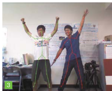
1. 1. 体節にマーカを装着して様々な競技動作を計測。清水助教自身は走り幅跳びの動作分析を行っているが、ゼミ生それぞれが自分の専門競技で分析しているため、データ収集の幅が広がっている。2. 実際の撮影の様子(全景)。3. 家庭用ゲーム機で使うモーションキャプチャデバイスを使えば、リアルタイムでスティックピクチャを表示させることも可能に。4. DLT法による3次元動作分析。複数の選手の動きを重ねれば、共通する部分とバラつきのある部分を視覚化できる。
