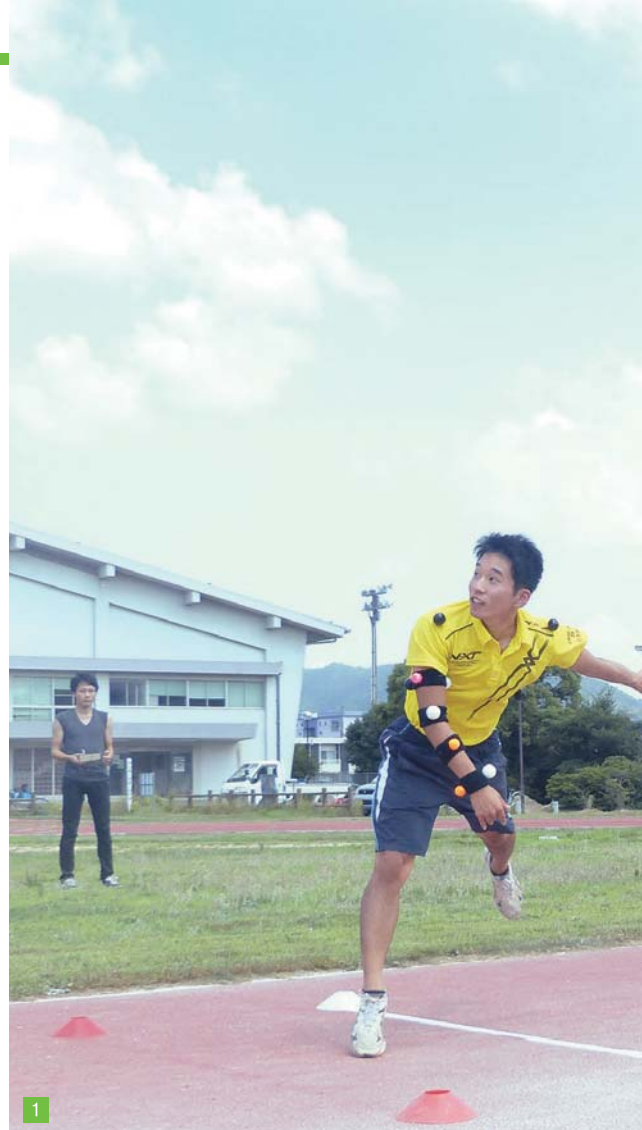
1. 1. 体節にマーカを装着して様々な競技動作を計測。清水助教自身は走り幅跳びの動作分析を行っているが、ゼミ生それぞれが自分の専門競技で分析しているため、データ収集の幅が広がっている。2. 実際の撮影の様子(全景)。3. 家庭用ゲーム機で使うモーションキャプチャデバイスを使えば、リアルタイムでスティックピクチャを表示させることも可能に。4. DLT法による3次元動作分析。複数の選手の動きを重ねれば、共通する部分とバラつきのある部分を視覚化できる。
