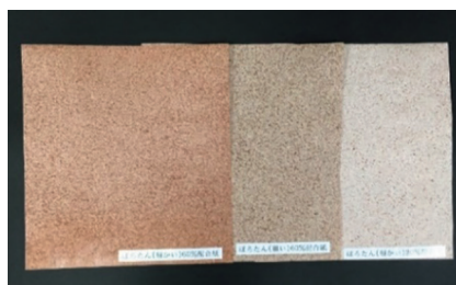
試作したクリ(果皮)の配合紙(左から配合60%, 40%, 20%)
