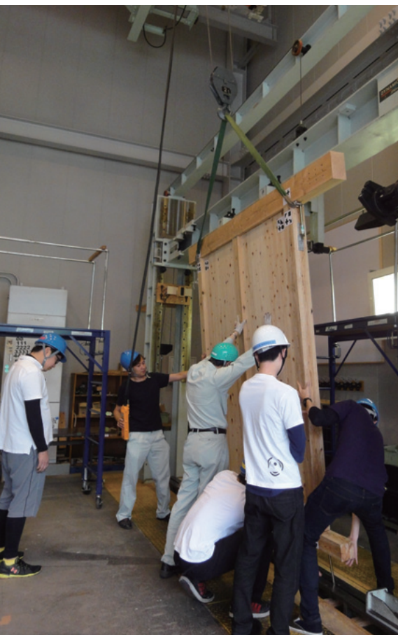
エコ3パネルを用いた耐力壁の壁倍率試験
