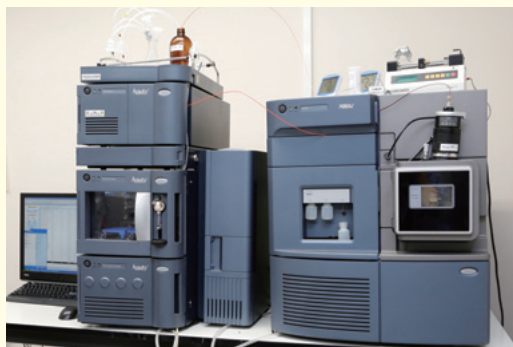
島根大学に備えられた液体クロマトグラフィ質量分析計
