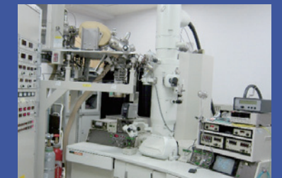
図2: 島根大学の透過電子顕微鏡(TEM)。イオン加速器と結合した、ユニークなTEM。
