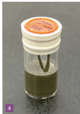
1. 無機材料物性工学研究室に所属する学生の実験の様子。2. 新准教授は研究において、各視点のバランスの重要性を強調する。3. 1000度に設定された窯で原料を固め、セメントを作る。4. 石灰石の種類や粒の細かさ、混入する薬液量を変えたサンプルをいくつも作成する。
