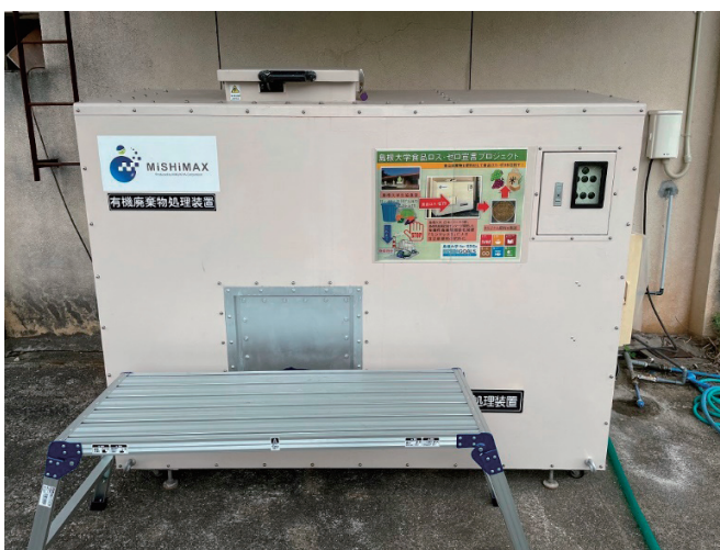
食品廃棄物を肥料化する発酵分解装置
