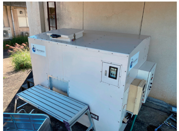
有機性廃棄物減容化装置「ミシマックス」への残飯投入
