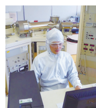
クリーンルームにて、超精密測定である鉛同位体比分析を行っている様子
