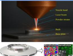
原子噴射三次元積層造形
