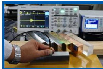
【超音波を使った材料の音速測定】
