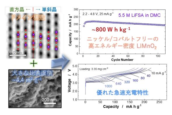
横浜国立大学・名古屋工業大学・島根大学の研究グループにおけるナノ構造を高度に制御 したリチウムマンガン酸化物 (LiMnO<sub>2</sub>) に関する研究成果の概要図
