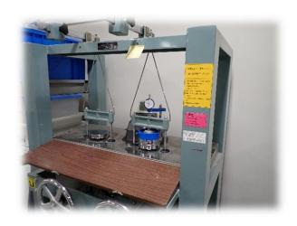
地盤材料の圧密試験の様子
