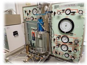
地盤材料の三軸せん断試験の様子
