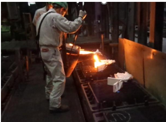
図1 溶かした鉄を砂の型に鋳造する様子 (地元企業での鋳造実験)
