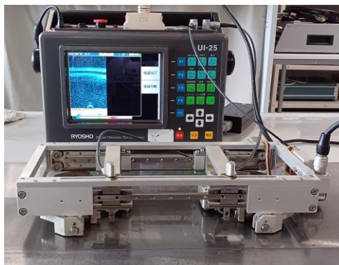
超音波TOFD法による映像化 (鋼板疲労き裂)
