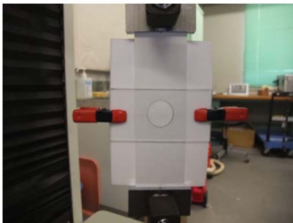
円孔を有するコピー用紙の引張試験
